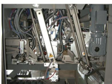
Le **TRANSFERT** est assuré par une paire de pendules, typiques de la gamme **BL**, qui soutiennent et déplacent le sac sans jamais le lâcher au cours des phases successives, avec un mouvement continu et fluide. En l'absence d'efforts et de vibrations, ces pendules garantissent un fonctionnement fiable et une longue durée de vie.
