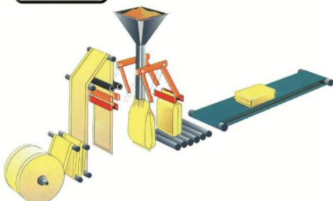
**La Formatura, il riempimento e la saldatura** del sacco sono eseguiti in tre differenti stazioni operanti simultaneamente.
