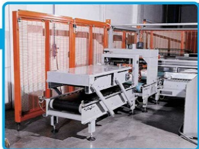
Pressatura del sacco prima della rotazione
